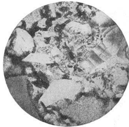
Fig. 12. V = 500 Retortenkohle als Gefügebstandteil einer Elektrode.
